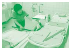
搬送車のまま入浴できる特殊浴槽▶
